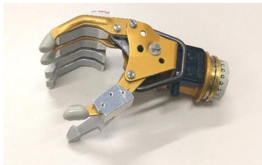
図 40 アタッチメントの指腹側形状は DMC ハンドと同様
