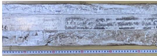
図2 製造されたMg/Alクラッド材の一部
