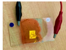
図2 塗工式有機 EL デバイスの発光時の様子
