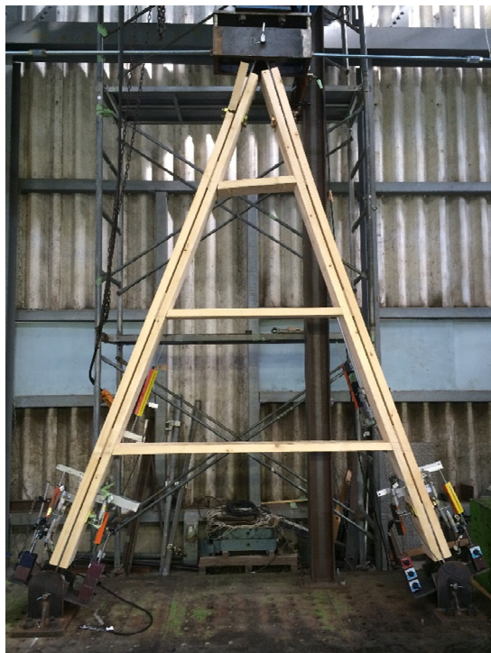
a) 全体最終破壊状況
