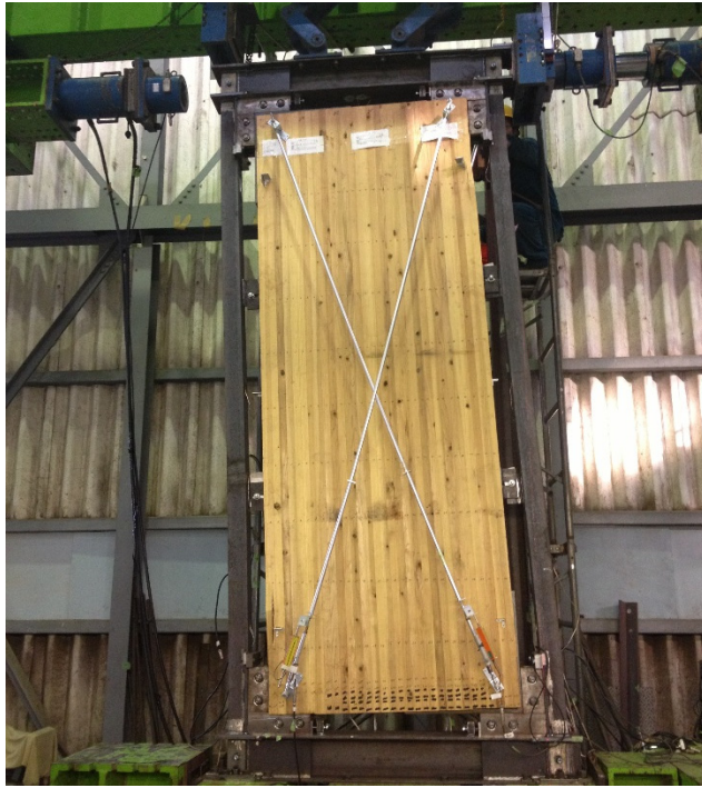
a) 全体の破壊状況
