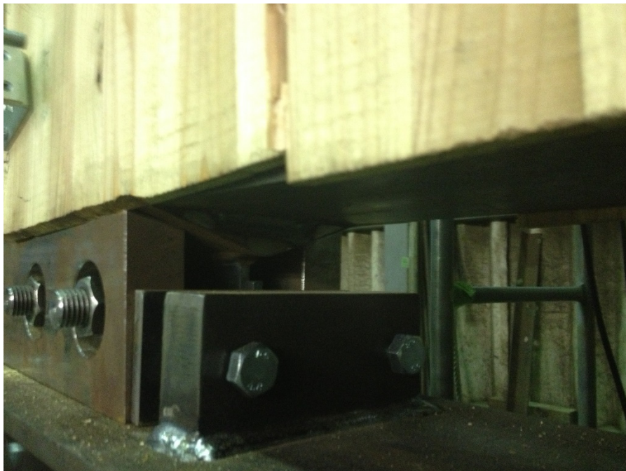
b) 木質パネルのせん断破壊状況
