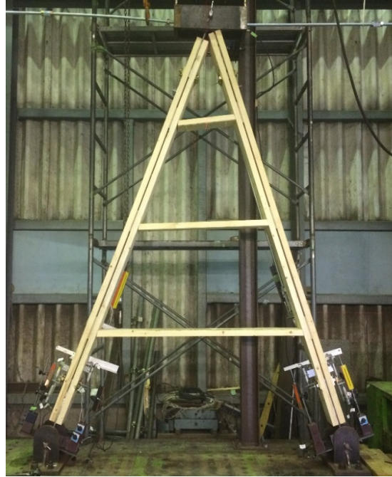
a) 全体最終破壊状況 (No1)
