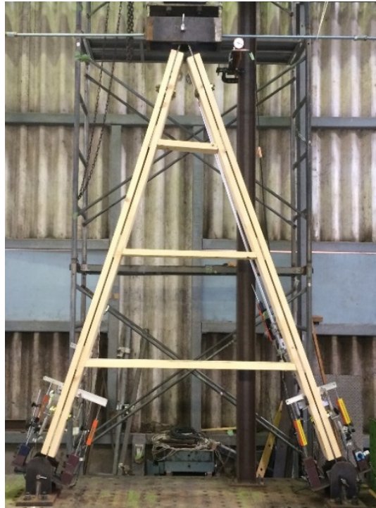
a) 全体最終破壊状況
