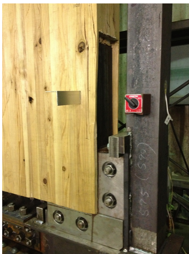
b) 木質パネル脚部のめり込み状況
