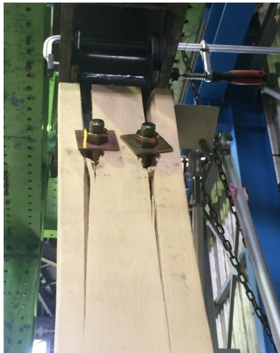
b) 柱頭部の割裂破壊状況
