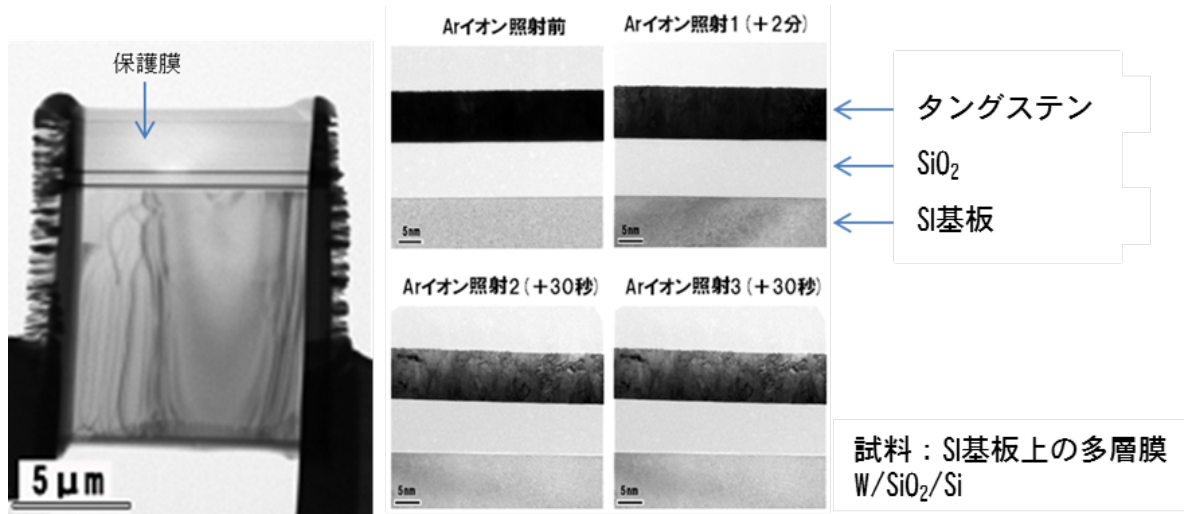
図 4.25d 薄膜試料のアルゴンイオン照射に対する変化
