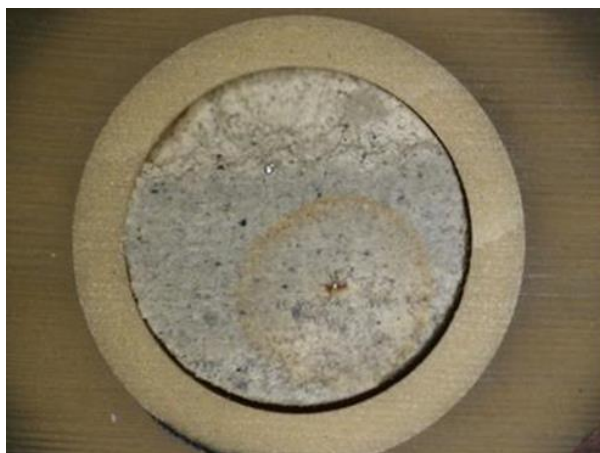
図 6-19 アノード側炭素鋼周辺の赤錆発生状況写真
