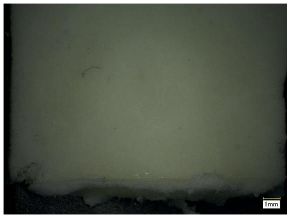
Fig. A.31 粉末卵白添加率 50%における KR4000G の破面画像
