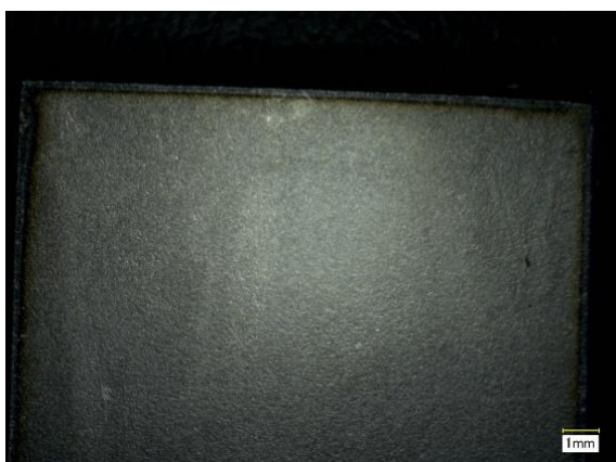
Fig. A.31 粉末卵白添加率 50%における KR4000G の破面画像
