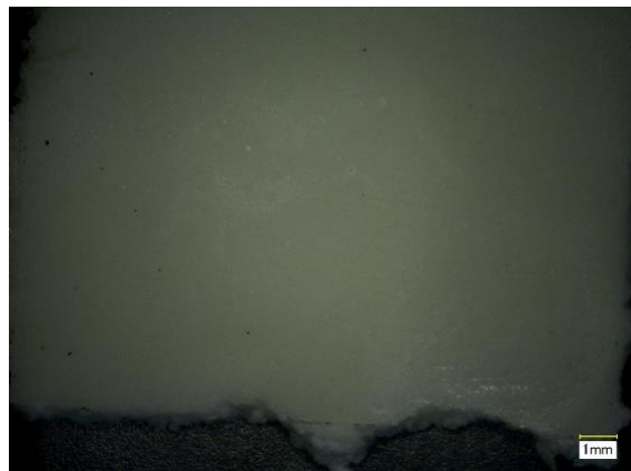
Fig. A.30 粉末卵白添加率 40%における KR4000G の破面画像
