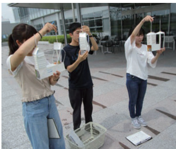
図1. 自作した百葉箱を用いた温度計測実験の様子
