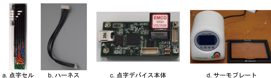
図 3-10. 低酸素細胞培養システムの構築 指板に点字セルを装着した箇所の外観および培養システムの構築に使用した機器を示した。
