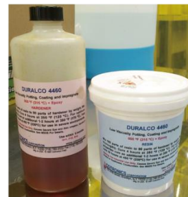
e. 耐熱エポキシ系接着剤 2 液混合型で硬化剤 (左) を主剤 (右) 重量比 10:8 で混合して使用した。
