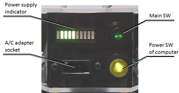
図 C.5 電装系用コントロールパネル
